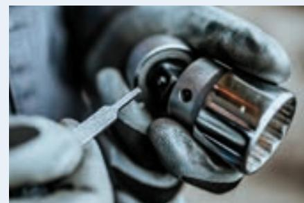
При установке головок или удлинителей положение отверстия в головке должно совпадать с положением штифта на приводном квадрате. При помощи ключа для смены торцевых головок (артикул 1111) надавите на штифт, одновременно надевая торцовую головку. Убедитесь, что штифт вошел в отверстие на головке.
