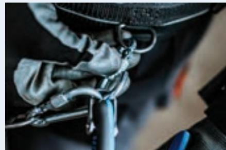
Откройте карабин на поясне и снимите с него инструмент с прикрепленной к нему стропой. Инструмент готов к использованию.
